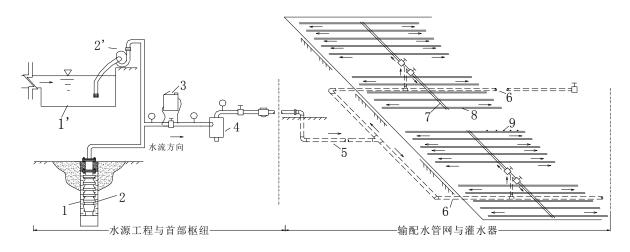
1. 地下水(1'. 地表水) 2. 潜水泵(2'. 离心泵) 3. 施肥罐 4. 过滤器 5. 主干管 6. 分干管 7. 支(辅)管 8. 毛管 9. 灌水器
